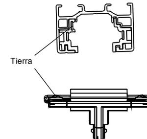
Asegurarse que las terminales de tierra del conector y del riel coincidan
