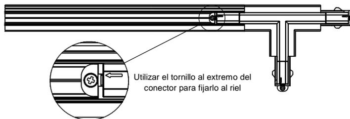
Utilizar el tornillo al extremo del conector para fijarlo al riel
