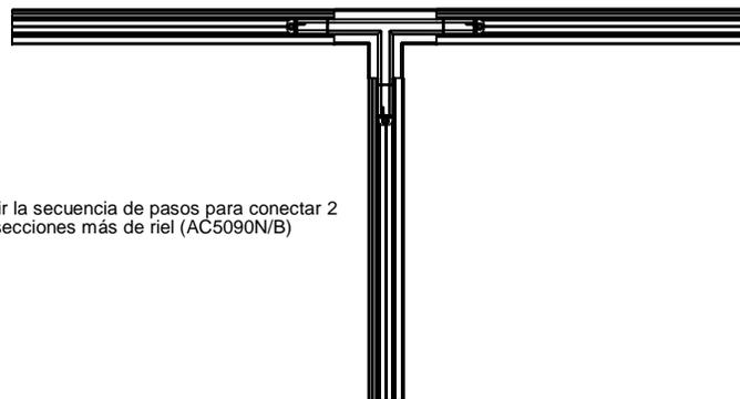
Repetir la secuencia de pasos para conectar 2 secciones más de riel (AC5090N/B)
