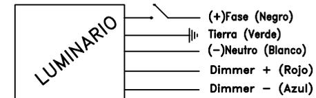
ARREGLO DE LEDS DE 78 W
